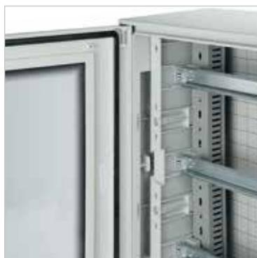
Il telaio è predisposto per il fissaggio di canali da cablaggio sui supporti delle guide DIN, con altezza minima di 40 mm anche con la guida in posizione più bassa e la piastra di fondo installata
